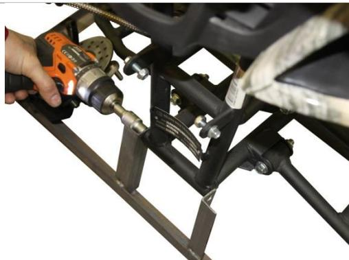
3.3.1. Выверните два болта крепления рамы квадроцикла к нижней части поддона головкой на 10мм. Эти болты вам потребуются в дальнейшем при фиксации дуг передней защиты.
