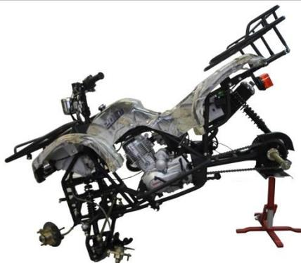
3.3.3. Для удобства установки колес с помощью помощника приподнимите квадроцикл, вытащите металлическую раму и подставьте под двигатель подставку. Квадроцикл должен быть надежно закреплен в данном положении!
