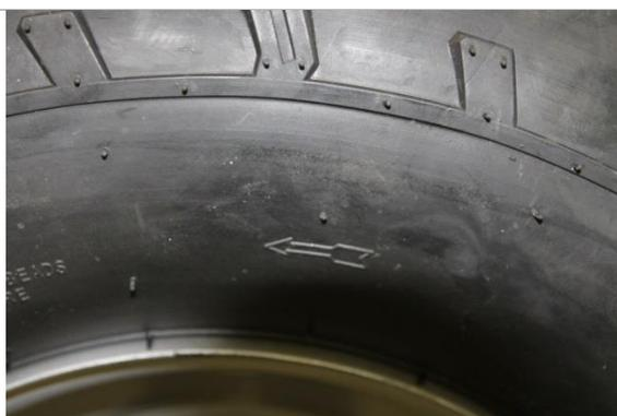
3.3.5. Перед установкой колёс проверьте направление протектора. Также вам могут помочь стрелки, показывающие правильное направление вращения колеса. **Правильно установленный протектор шин существенно улучшает управляемость квадроцикла и уменьшает тормозной путь.**
