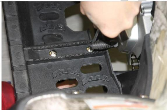
3.6.4. Установленный пластик зафиксируйте с помощью коротких болтов в верхней части, удерживая гайку головкой на 10мм и закручивая болт крестовой отверткой.
