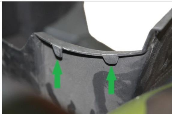
3.6.3. Установите подножку таким образом, чтобы совпали отверстия под крепёжные болты. При этом необходимо выступы на подножке установить в пазы пластика кузова (показаны с помощью стрелок на рисунках).
