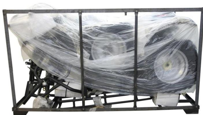
Квадроцикл поставляется в частично разобранном виде. Достаньте идущие в комплекте части квадроцикла и коробки с комплектующими. Раскрутите болты металлического каркаса.
