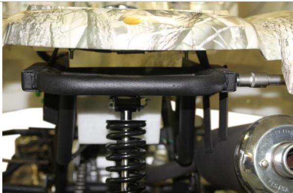
3.2.1. Выкрутите из рамы четыре болта крепления кронштейна заднего багажника головкой на 13мм.
