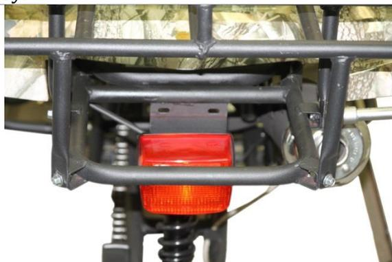
3.2.6. Прикрутите багажник к кронштейну ранее выкрученными болтами.
