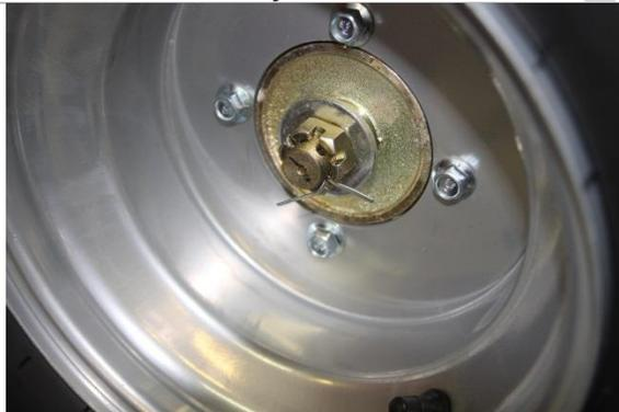
3.3.8. Накрутите гайку и затяните головкой на 30мм.
