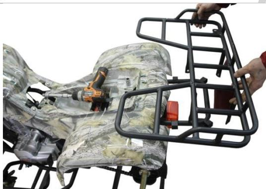
3.2.5. Соедините вместе кронштейн крепления заднего багажника с багажником таким образом, чтобы совпали отверстия под крепёжные болты.
