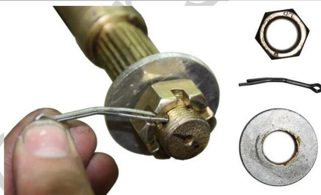
3.3.4. Перед установкой колеса вытащите шплинт, выверните гайку крепления колёс и шайбу со ступицы с левой и правой стороны.
