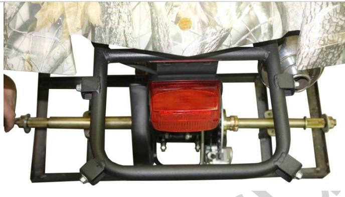
3.2.2. Установите кронштейн крепления заднего багажника и прикрутите ранее выкрученными болтами.
