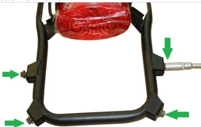
3.2.3. Выкрутите четыре болта с кронштейна крепления заднего багажника головкой на 10мм.
