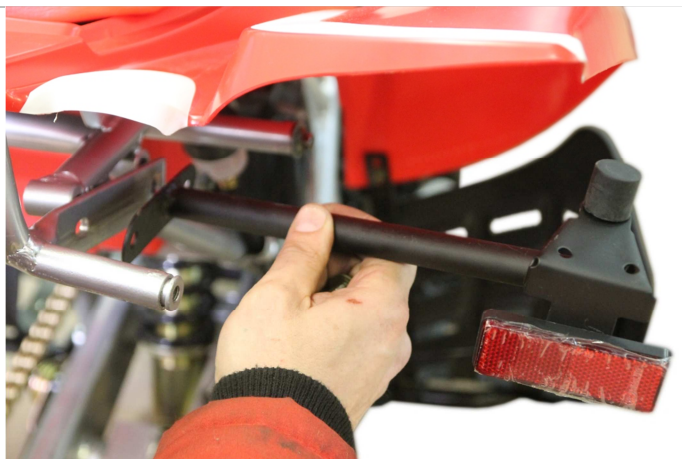
3.3.5. Соединяем вместе кронштейн крепления заднего багажника кронштейном усиления заднего крыла.
