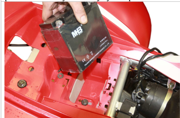
3.10.3. Установите АКБ в аккумуляторный отсек.
