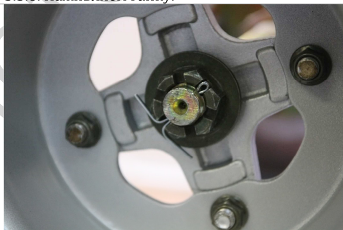
3.5.10. Фиксируем гайку большим шплинтом.
