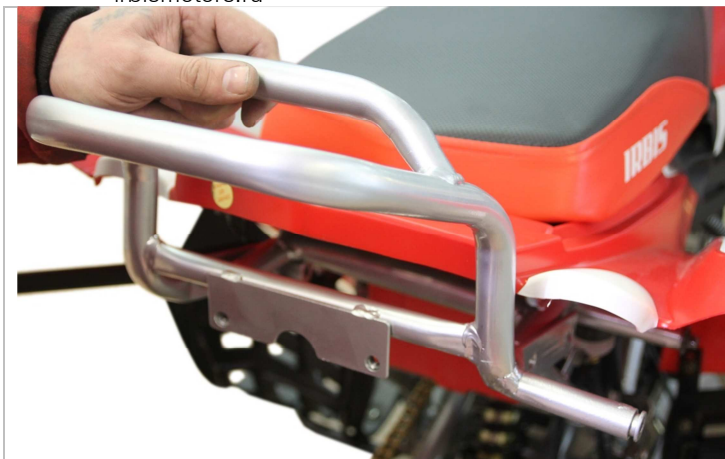
3.3.4. Устанавливаем задний багажник.
