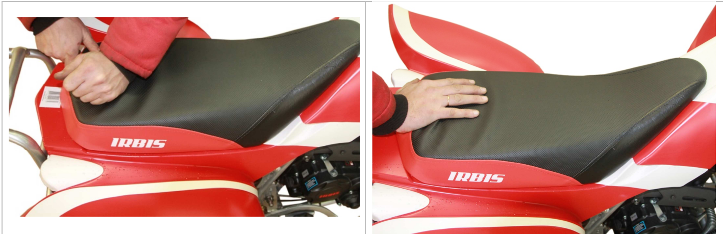
3.12.2. Нажимая на его заднюю часть, сдвигаем кресло вперед до характерного щелчка.
