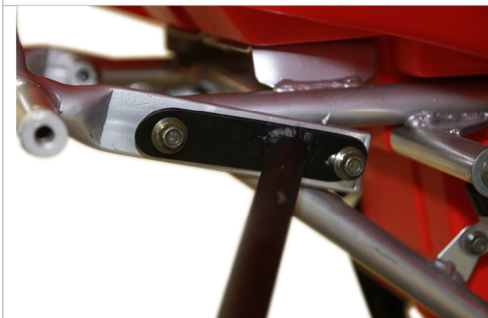
3.3.6. Фиксируем их ранее выкрученными болтами.
