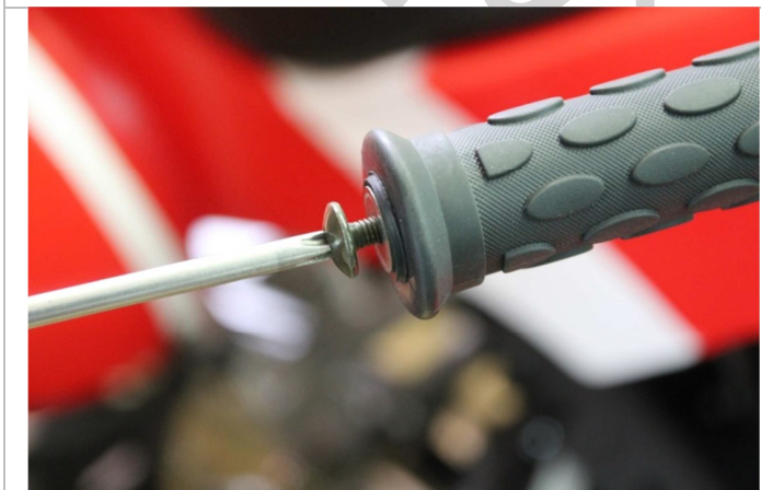
3.13.3. С помощью крестовой отвертки выкручиваем винт в торце ручки руля и два винта в торце кронштейна крепления.
