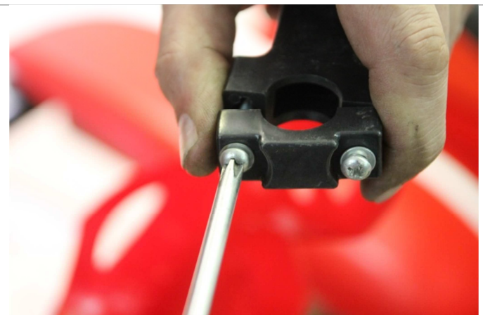
3.13.3. С помощью крестовой отвертки выкручиваем винт в торце ручки руля и два винта в торце кронштейна крепления.
