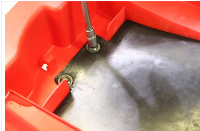
3.10.1. Откручиваем два болта крепления резиновой заглушки аккумуляторного отсека.
