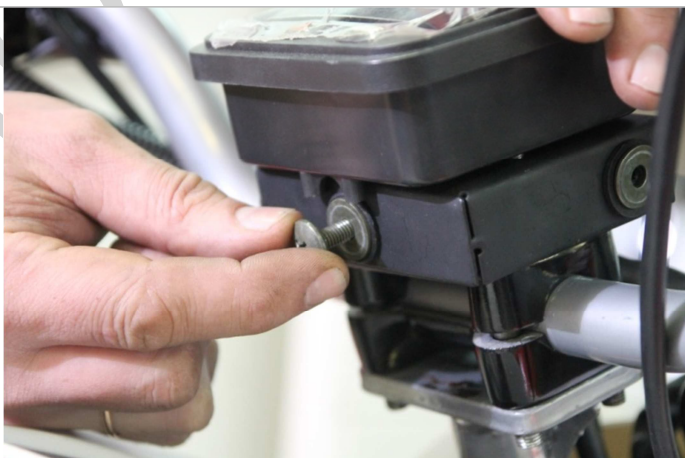
3.2.6. Устанавливаем приборную панель на планки крепления. Наживляем в трех точках крепления приборной панели к кронштейну крепления ранее выкрученные болты.
