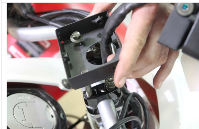
3.2.4. Поочередно выкручивая болты крепления хомута руля, наживите кронштейна крепления панели приборов к рулю.
