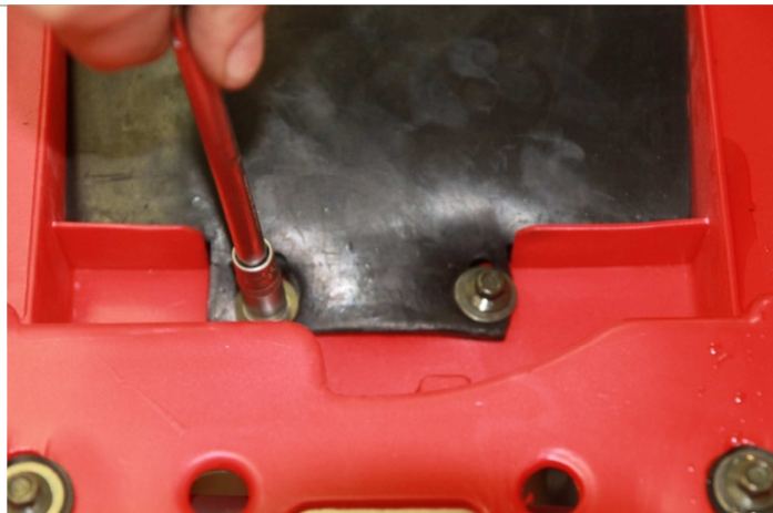
3.10.7. Фиксируем ее ранее выкрученными болтами.
