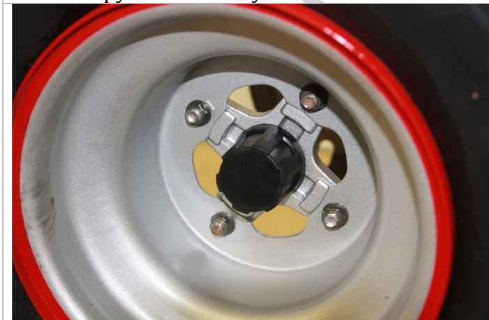
3.5.11. Устанавливаем резиновую заглушку.
