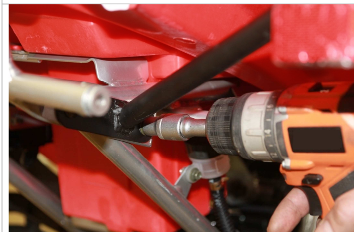
3.3.8. Закручиваем болты крепления с левой и правой сторон квадроцикла.
