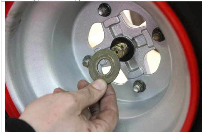
3.5.7. Затем одеваем на ось большую шайбу.
