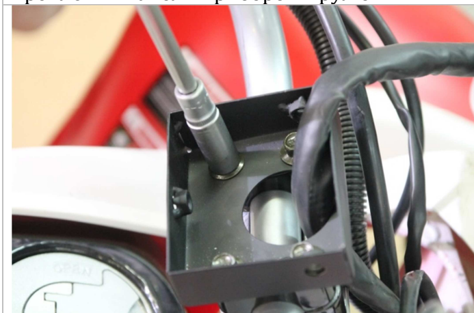
3.2.5. Установите руль в нужное положение и затяните болты крепления кронштейна панели приборов к рулю.
