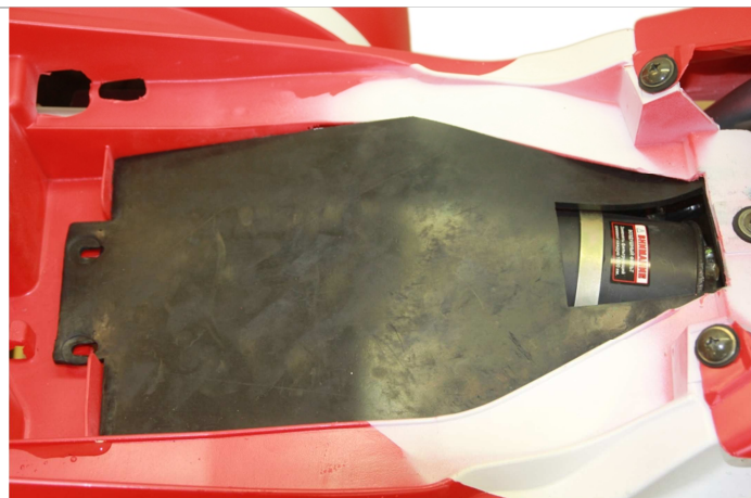
3.10.6. Устанавливаем обратно резиновую заглушку.
