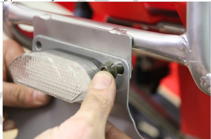
3.4.4. Устанавливаем фонарь к кронштейну, расположенному на заднем багажнике. Фиксируем его с помощью болтов из комплекта поставки.
