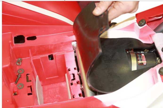
3.10.2. Снимаем резиновую заглушку.
