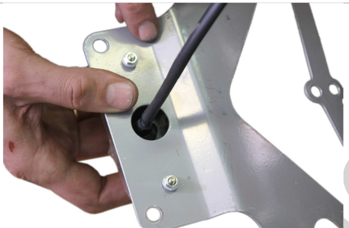
3.4.3. Прикручиваем фонарь к кронштейну ГНЗ.
