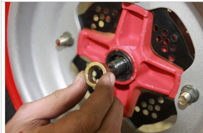
3.7.8. Одеваем втулку на ось и устанавливаем ее так, как указано на рисунке.
