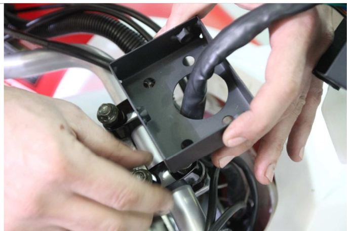
3.2.3. Поочередно выкручивая болты крепления хомута руля, наживите крепления кронштейна панели приборов к рулю.
