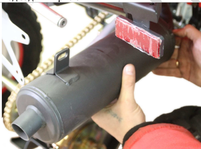
3.11.3. Устанавливаем выхлопную трубу, стыкуя ее с трубой, идущей от двигателя.
